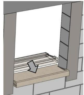
Retirer l'appui vers soi jusqu'au contact de l'oreille sur la maçonnerie.
