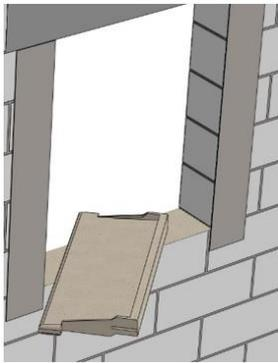
Se placer à l'intérieur de la construction pour insérer l'appui MSEA.
